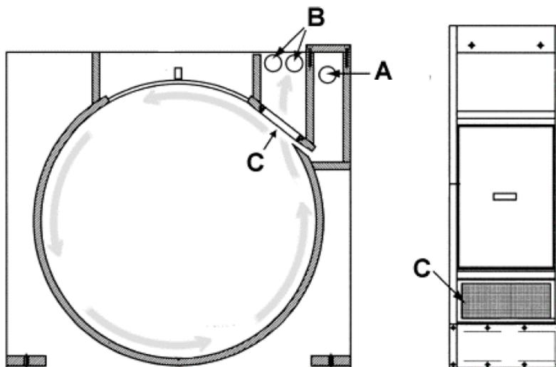
Es un tipo de acuario cuya particularidad es que en su zona central mantiene una forma cilíndrica sin esquinas, en esta zona se induce la generación de corrientes mediante la disposición de la entrada y salida del agua evitando a toda costa la generación de burbujas.
